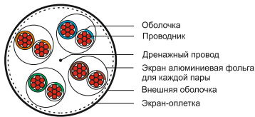
Рисунок 6 – Конструкция патч-корда категории 6d типа S/FTP
